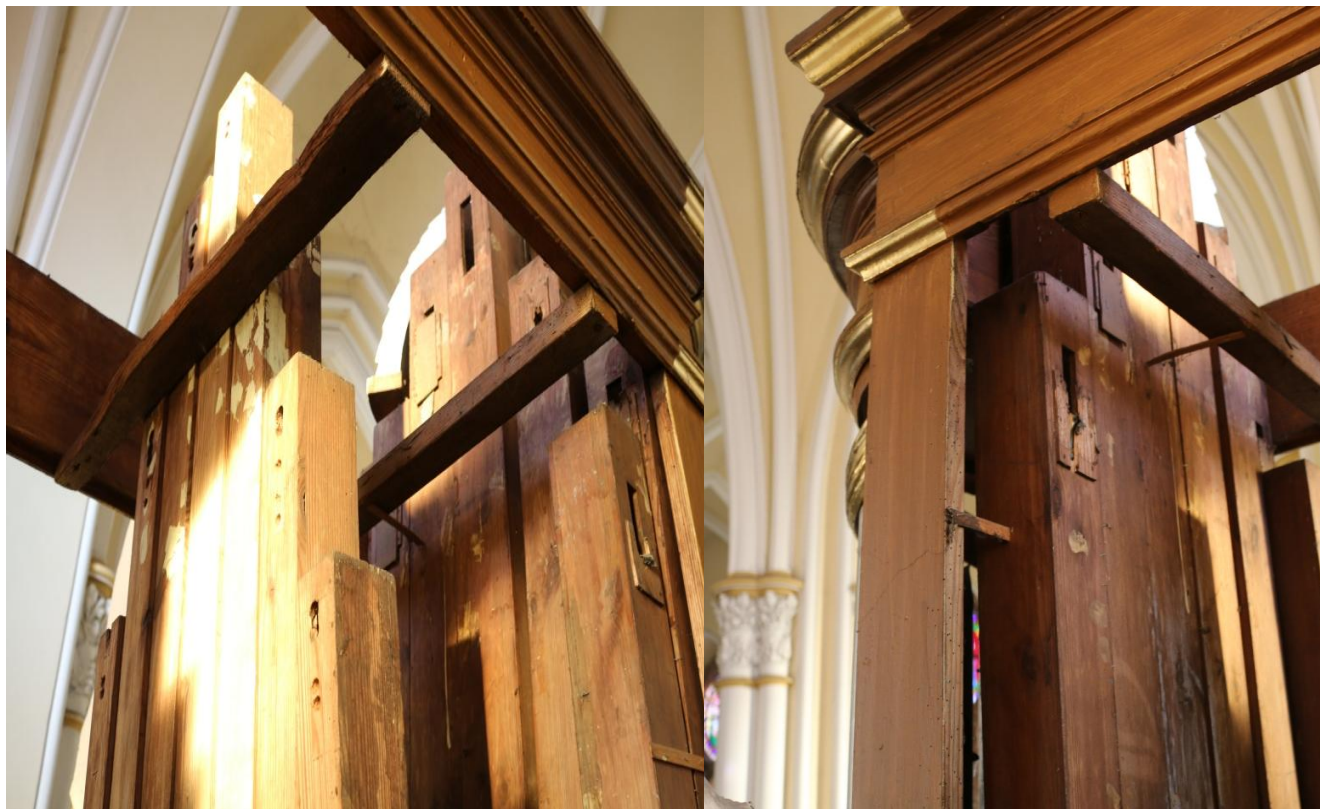
Fot.8. Braki w stroikach i uszkodzenia piszczałek drewnianych
