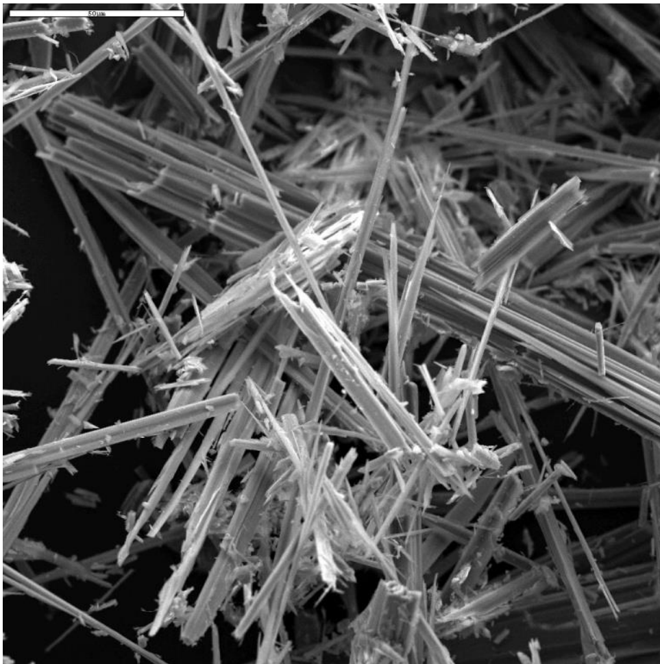
Rys. 2. Włókna azbestu zawarte w eternicie: widok pod mikroskopem optycznym w świetle przechodzącym
